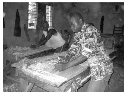
Snickarelever gör nya fönsterluckor till elevhemmet.
